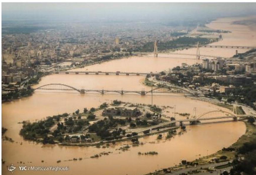
شکل ۱۲. پل‌ها به عنوان گلوگاه‌های گذردهی سیلاب رودخانه از میان شهر اهواز
