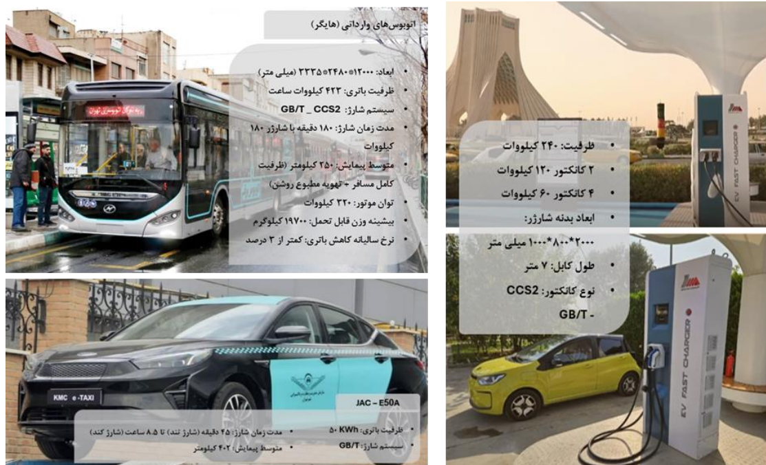
شکل ۸. مشخصات فنی یکی از شارژرها، اتوبوس‌ها و تاکسی‌های برقی وارداتی در ایران
